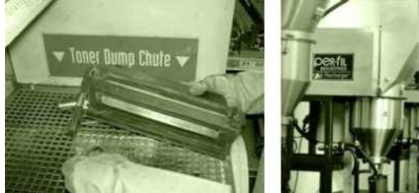
Foto 3 (links): het verwijderen van de resttoner gebeurt in een speciale ruimte met afzuiging om elk contact met het carbon black te voorkomenn Foto 4 (rechts): hervultoestel voor tonercartridges
